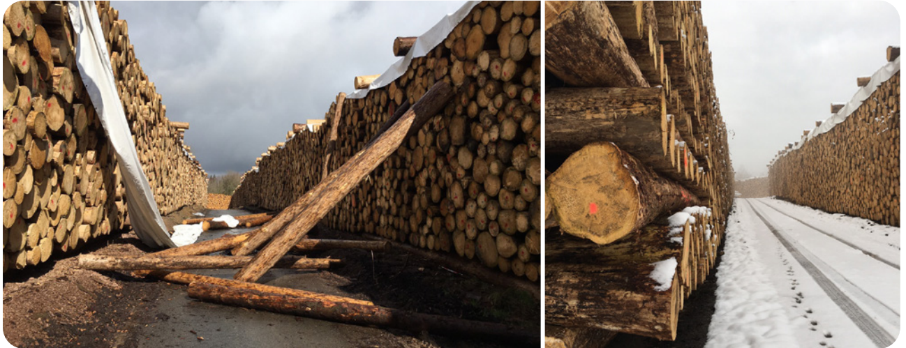
Abbildung 7 Links: heruntergefallene Stammabschnitte und Folie nach einem Sturmereignis; Rechts: Querlieger an den Seiten des Polters, um das Wegrollen der Stämme zu verhindern an Trockenlagern der Firma Egger Sägewerk Brilon GmbH (Bilder: Egger Sägewerk Brilon GmbH)
