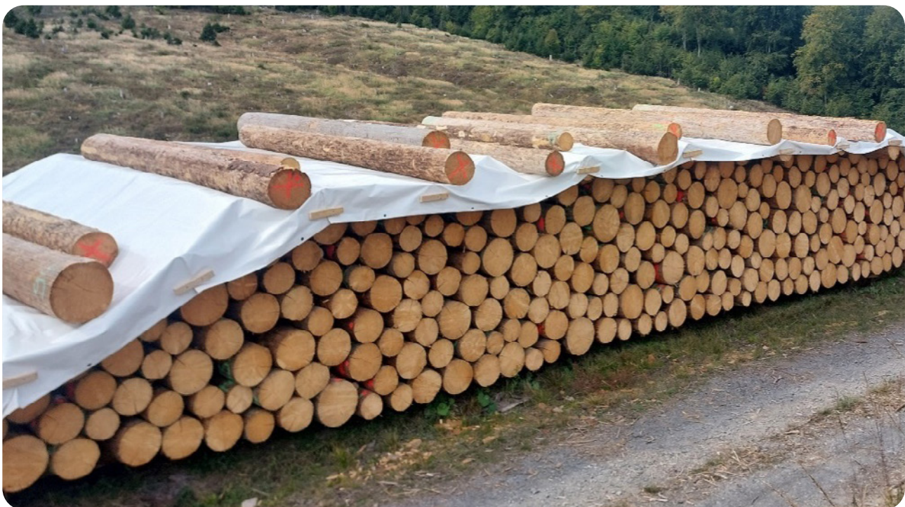
Abbildung 3: Anlage eines „Best-Practice-Trockenlagers“ nach derzeitigem Stand der Technik im Raum Arnsberg, Nordrhein-Westfalen. (Bild: Dr. Lukas Emmerich, Landesbetrieb Wald und Holz NRW)
