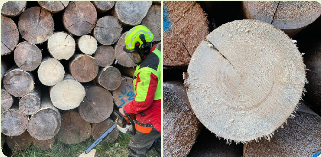
Abbildung 4: Probeanschnitte im Rahmen des jährlichen Qualitätsmonitorings an einem Trockenlager der Egger Sägewerk Brilon GmbH nach drei Jahren Lagerdauer (Bilder: Egger Sägewerk Brilon GmbH, 2019)
